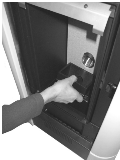
Fig. 27 - Wyjmowanie rusztu paleniskowego
