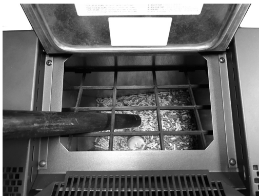
Fig. 32 - Czyszczenie zbiornika i ślimaka
