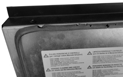
Fig. 23 - Zniszczona uszczelka
